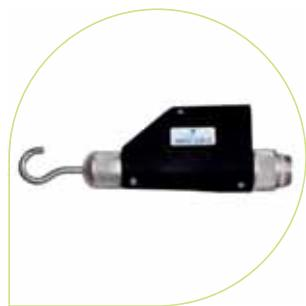
Указатель имеет наглядную комбинированную светозвуковую сигнализацию, позволяет определить наличие опасного напряжения на ВЛ и ПС до 220 кВ без заземляющего тросика. Яркая индикация контактной части хорошо заметна даже в солнечный день на фоне неба. Используются литиевые элементы питания, заменяемые один раз в 2–3 года.
